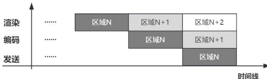
图3 端云系统实现分块作业的并行原理图
